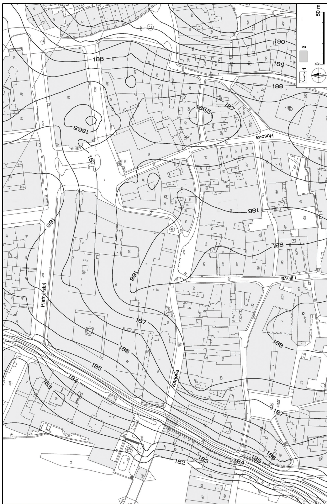
Obr. 9. Praha 1 - Staré Město, Karlova ulice s širším okolím. Pokus o rekonstrukci vrstevnicového plánu georeliéfu na redukováném snímku katastrální mapy. Vysvětlivky: 1 – podle nadmořské výšky původní úrovně podloží zastavené v 83 dokumentačních bodech z 239 realizovaných (cf. obr. 4:1–4) rekonstruováno pomocí počítačového programu SURFER fy Golden Software metodou Kriging, 2 – zastavěná plocha. Nadmořská výška vrstevnic byla ponechána ve výškovém systému Jadran. Digitalizace J. Hlavatý a M. Křemen.
